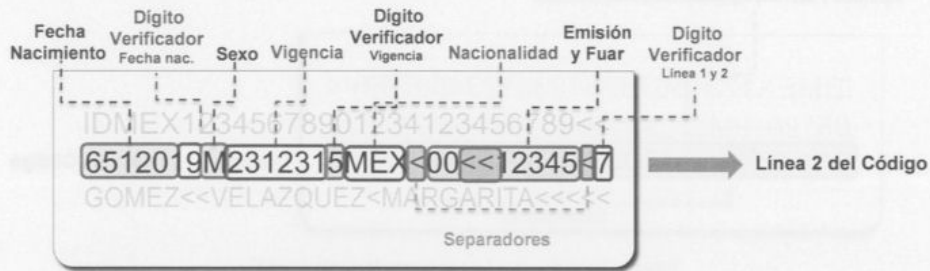
Figura 5. Descripción de la Zona de Lectura Mecánica, Línea 2
