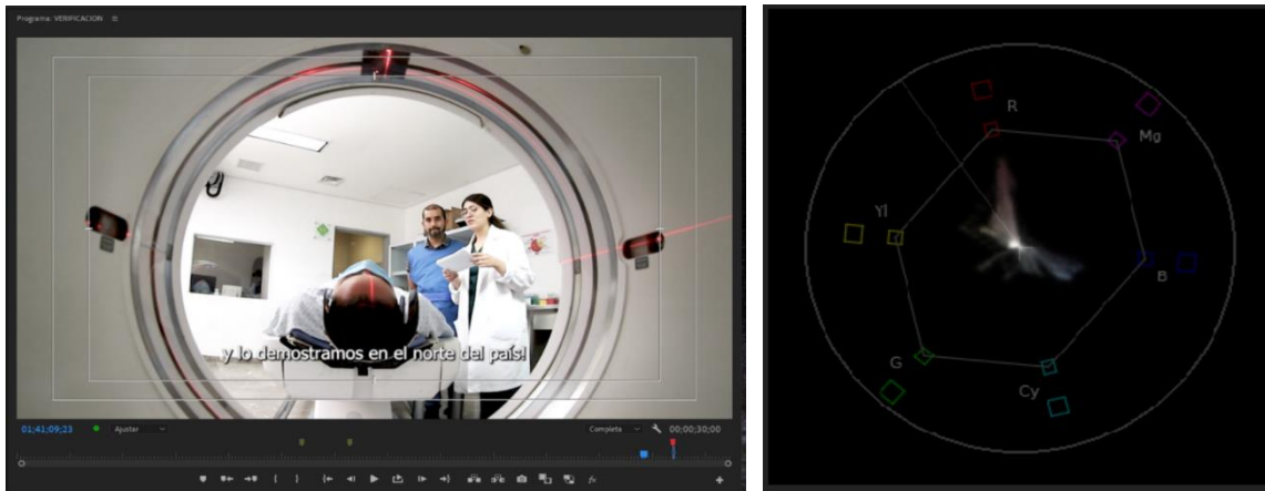
Ilustración 22. Imagen con problemas de Gamut y Vectorscopio que muestra la medición de saturación de color de la imagen
