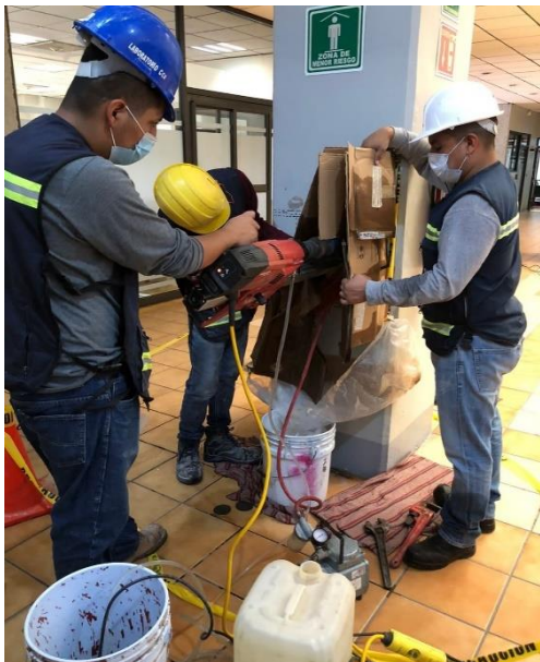
Prueba de Extracción de corazones en trabes y columnas
