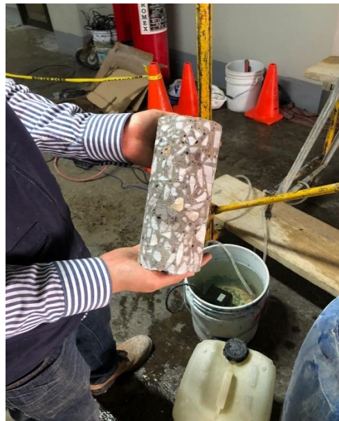
Prueba de Extracción de corazones en trabes y columnas
