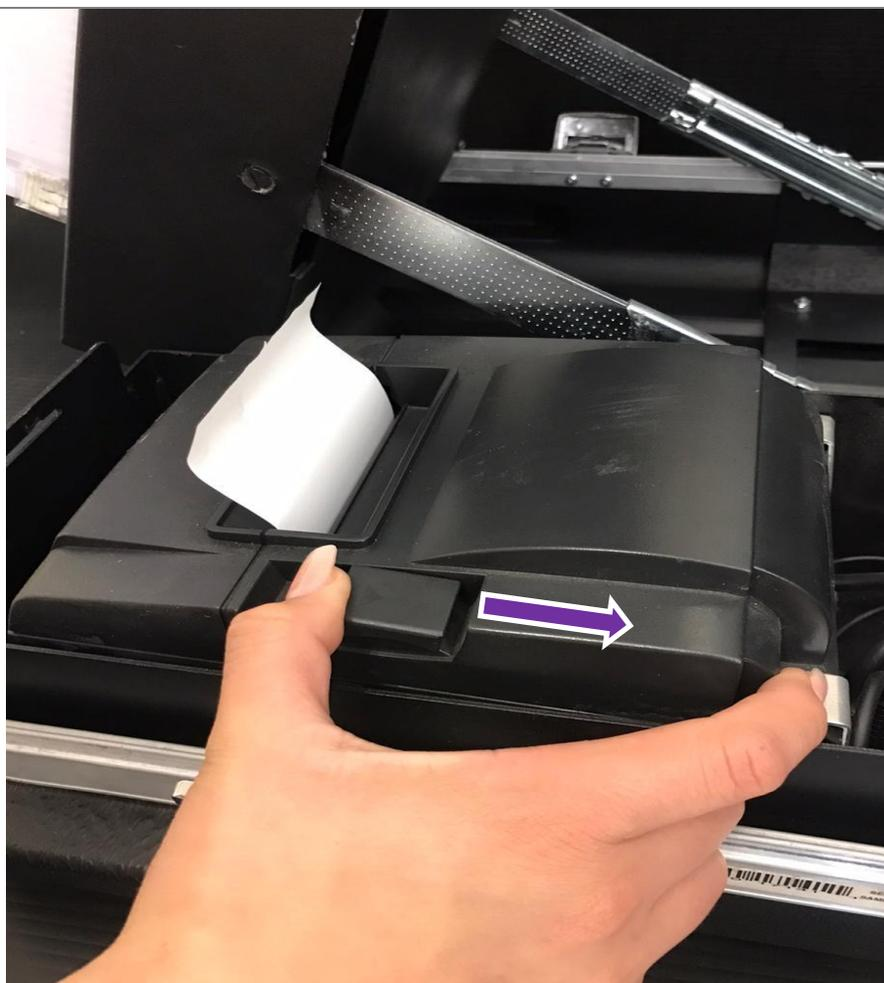
Desplazamiento del botón de seguridad de la cubierta de la impresora.
