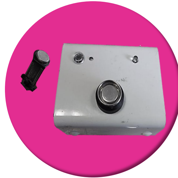
LLAVE CHIP PARA ACTIVAR Y CAMBIAR DE FASE LA URNA E INDICADORES LED
