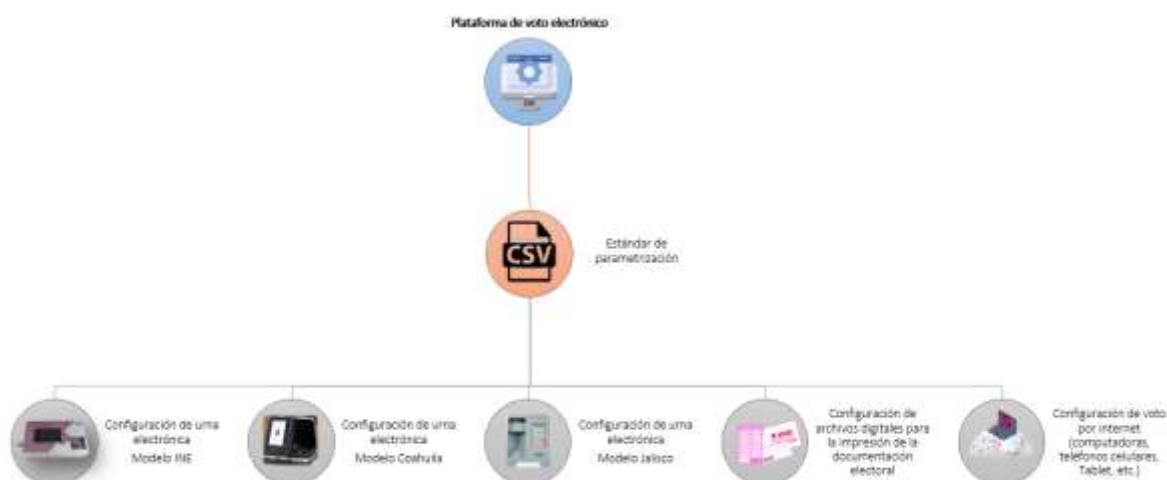
Figura 1. Esquema de funcionamiento de la plataforma de voto electrónico para la parametrización y configuración de dispositivos de votación
