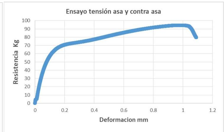
**GRAFICOS Lado izquierdo:** ensayos de tensión de la cinta o correa de la caja electoral, en este caso el grafico del Licitante 4 se sobrepone al grafico del licitante 2. **Lado derecho:** ensayo de tensión de asa y contra asa de caja electoral, mismo comportamiento en las muestras de los 4 licitantes
