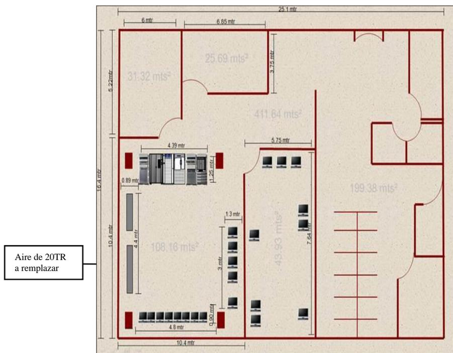
Figura 1.- Ubicación del Aire Acondicionado de 20 TR en Site en el 3er Piso del Edificio Quantum.
