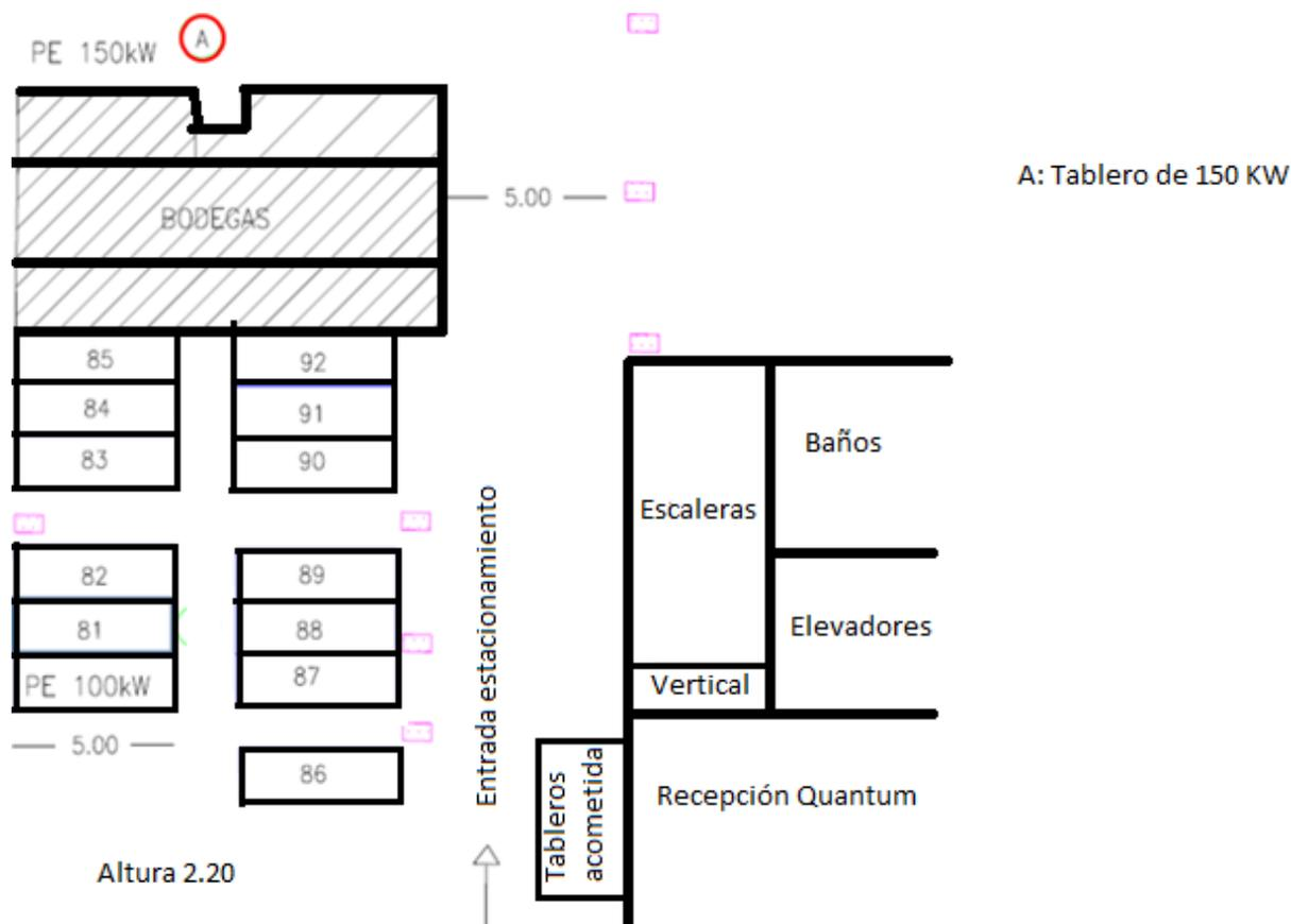
Figura 3 - Ubicación de la planta de emergencia de 150 KW
